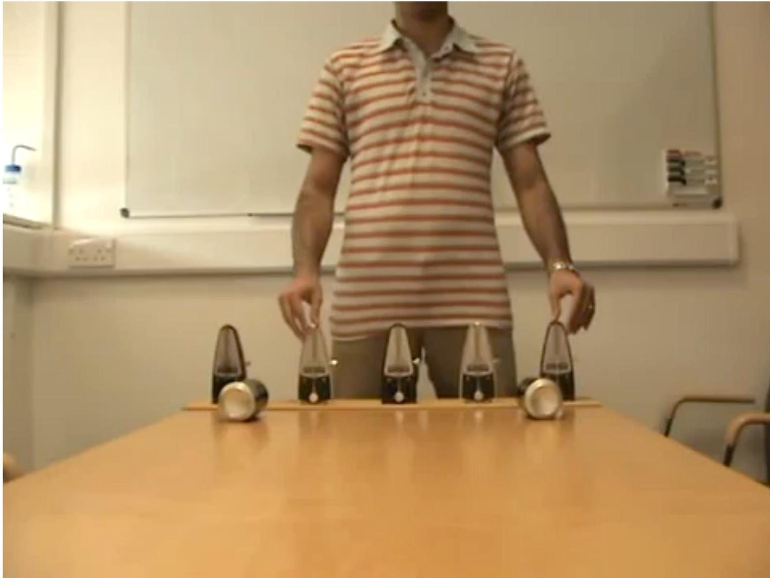
Le phénomène d'entraînement : les métronomes initialement asynchrones, mais réglés au même tempo, se synchronisent ensuite par transmission de l'énergie oscillatoire.
